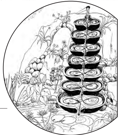
Teknolojia ba Futuru iha Timor Lorosa'e Flow Forms halo husi rai belit bele ajuda tais no hamo'os wee foer no aumenta oksijénium iha wee laran
